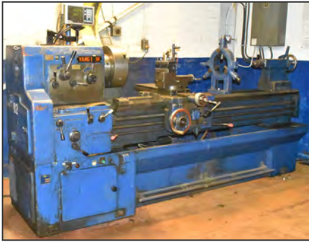
YANG IRON 1500HG gap bed engine lathe
